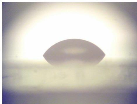
รูป 5 หยดน้ำบนผิวแก้วที่ถ่ายภาพจากเครื่องวัดมัมอย่างง่าย
